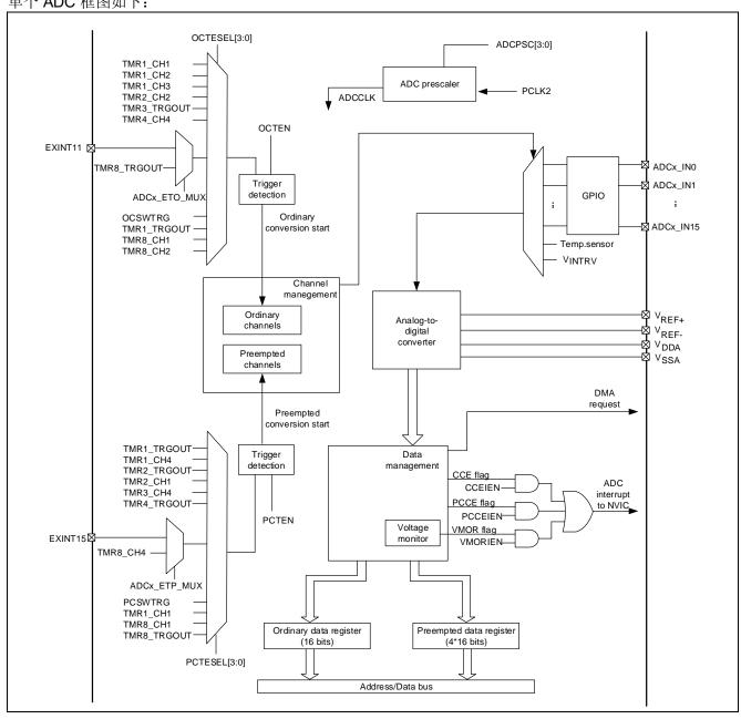
如上图所示,ADC 支持多种的外部触发方式,并且 ADC1 和 ADC2 支持双 ADC 模式。所以可以 ADC1 和 ADC2 采用双 ADC 模式(普通同时模式), ADC3 与 ADC1 和 ADC2 采用相同的触发源以达到同步的效果。 得到转换结果后通过 DMA 将数据传送到内部 SRAM 中。
